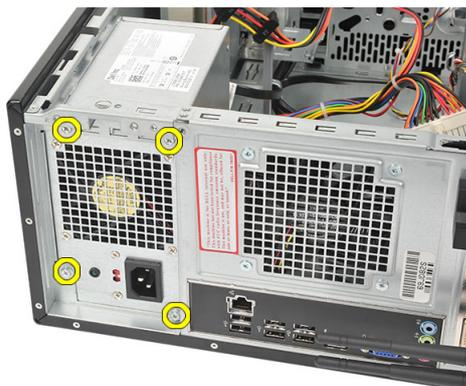
5. Premere il pulsante di sblocco presente sul fondo del telaio del sistema, quindi far scorrere l'unità di alimentazione verso la parte anteriore del computer.
