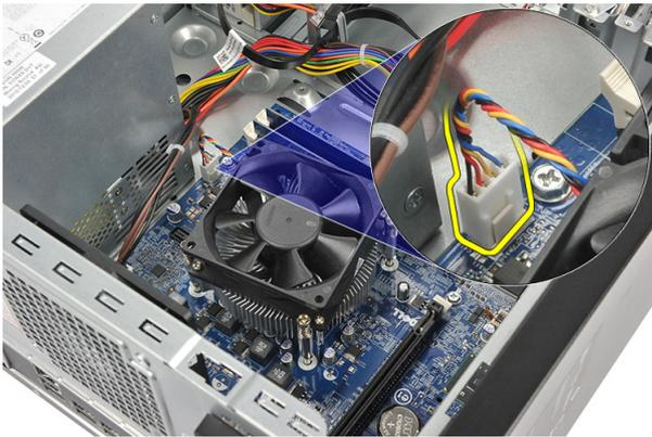
4. Allentare le viti che fissano il gruppo dissipatore di calore e ventola alla scheda di sistema.
